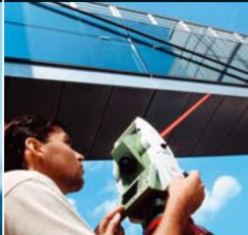
EDM senza riflettore (RL) con puntamento laser
